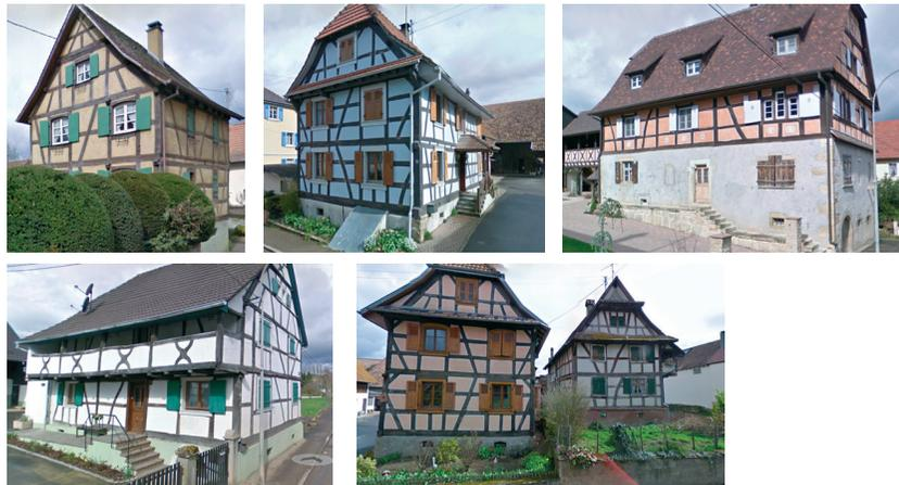
structure carrée à colombages, sous-sol enterré ou semi-enterré, à un ou deux étages avec niveau sous comble, perron à escalier donnant sur la cour, toiture fortement inclinée. Quelques édifices possèdent des façades ornementées (croix de Saint-André, disques radiés...) et des balcons galeries en encorbellement sur le mur gouttereau.
